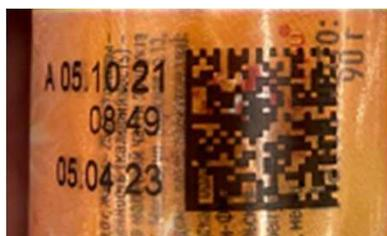
Печать кода маркировки на бликующей/светоотражающей поверхности
