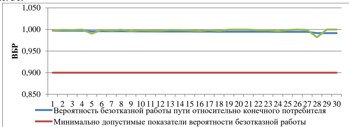
Рисунок 31. ВБР относительно участка тепловой сети от камеры «Вывод - Котельная № 5» до потребителя по ул. Семакова, 58
