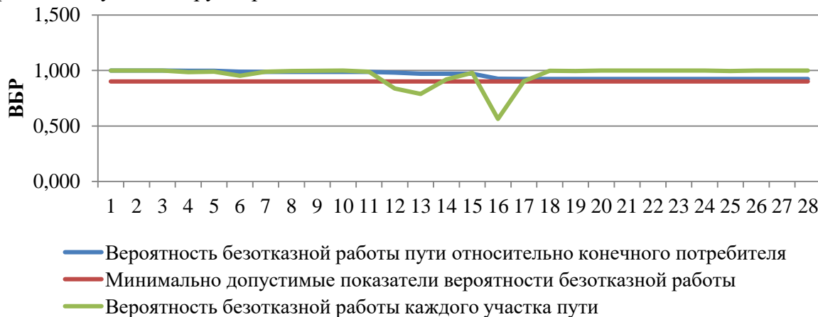
Рисунок 43. ВБР относительно участка тепловой сети от камеры «Вывод Котельная № 14» до потребителя по ул. 1-я Луговая, 48
