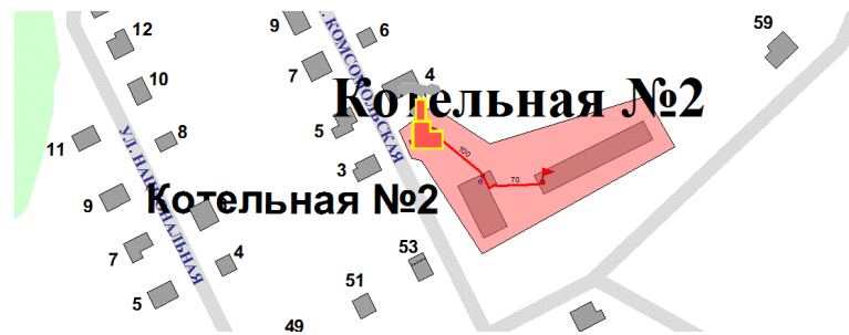
Рисунок 72. Трассировка участка тепловой сети от камеры «Вывод - Котельная № 2» до потребителя по ул. Октябрьская, 57
