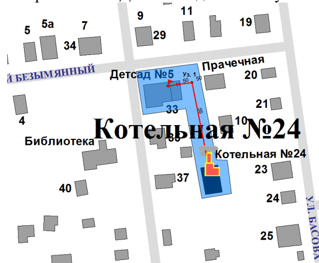
Рисунок 48. Трассировка участка тепловой сети от камеры «Вывод - Котельная № 24» до потребителя «Детский сад № 5 «Голубок»
