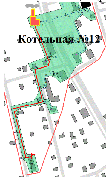
Рисунок 38. Трассировка участка тепловой сети от камеры «Вывод - Котельная № 12» до потребителя по ул. Гоголя, 41
