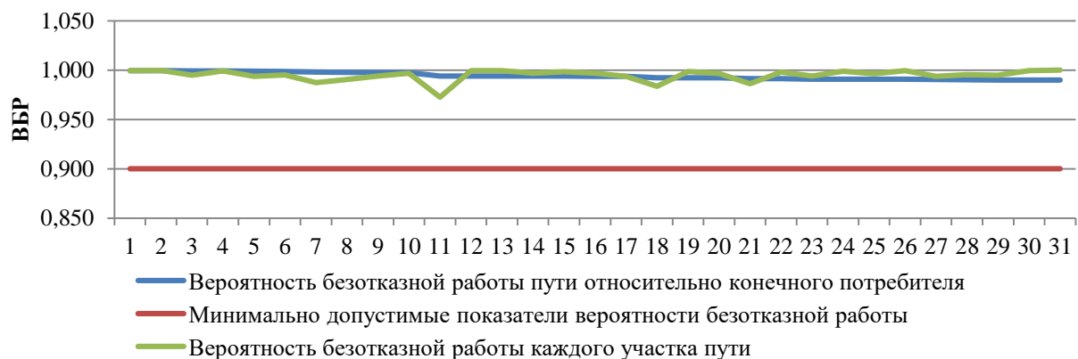
Рисунок 33. ВБР относительно участка тепловой сети от камеры «Вывод - Котельная № 6» до потребителя по ул. Зеленая, 101
