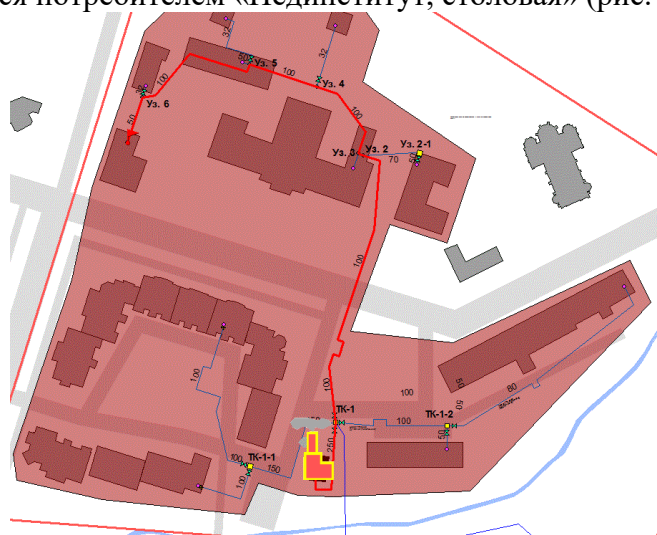
Рисунок 43. Трассировка участка тепловой сети от камеры «Вывод - Котельная № 17» до потребителя «Пединститут, столовая»
