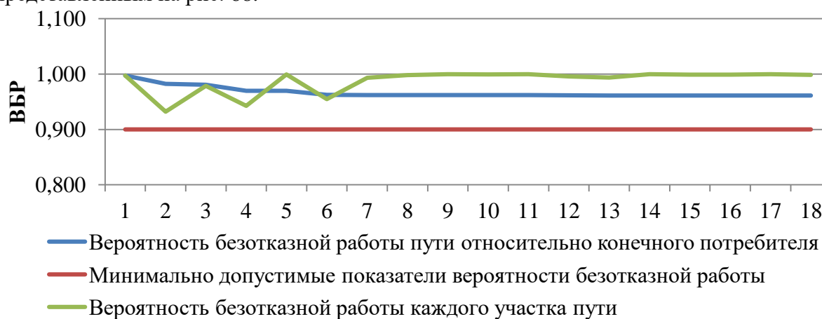
Рисунок 70. ВБР относительно участка тепловой сети от камеры «Вывод - Котельная № 11» до потребителя по ул. Водников, 3.
