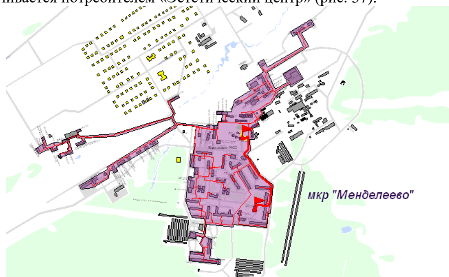
Рисунок 59. Трассировка участка тепловой сети от камеры «Вывод - Котельная № 22» до потребителя «Эстетический центр»
