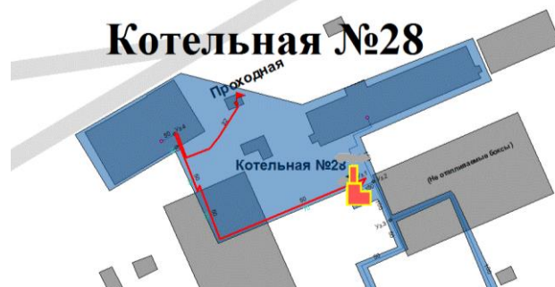
Рисунок 73. Трассировка участка тепловой сети от камеры «Вывод - Котельная № 28» до потребителя «Проходной МЧС»
