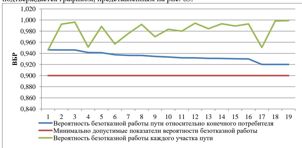
Рисунок 63. ВБР относительно участка тепловой сети от камеры «Вывод - Котельная № 16» до потребителя ул. Крупской, 16, Южакова Г.Г.
