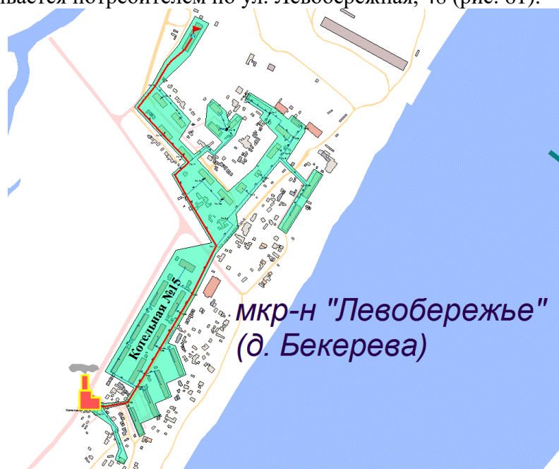
Рисунок 61. Трассировка участка тепловой сети от камеры «Вывод - Котельная № 15» до потребителя по ул. Левобережная, 48
