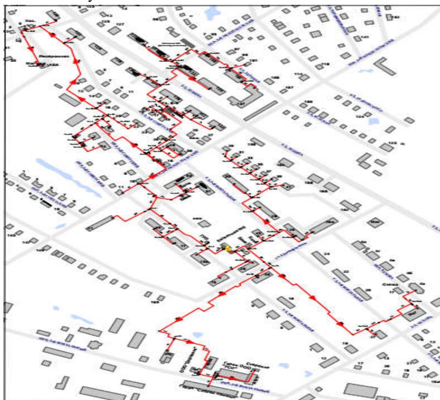
Рисунок 7 Схема тепловых сетей котельной №6
