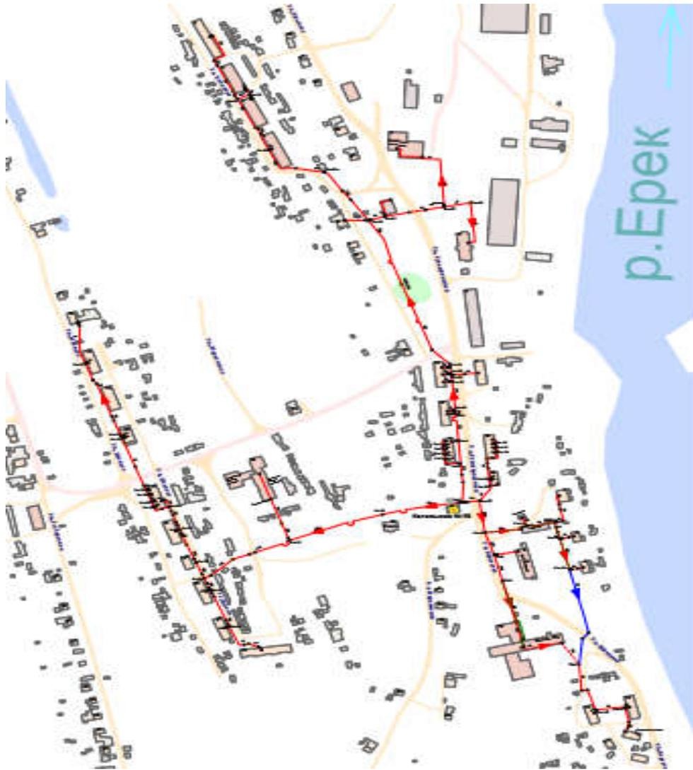
Рисунок 25 Схема тепловых сетей котельной №19
