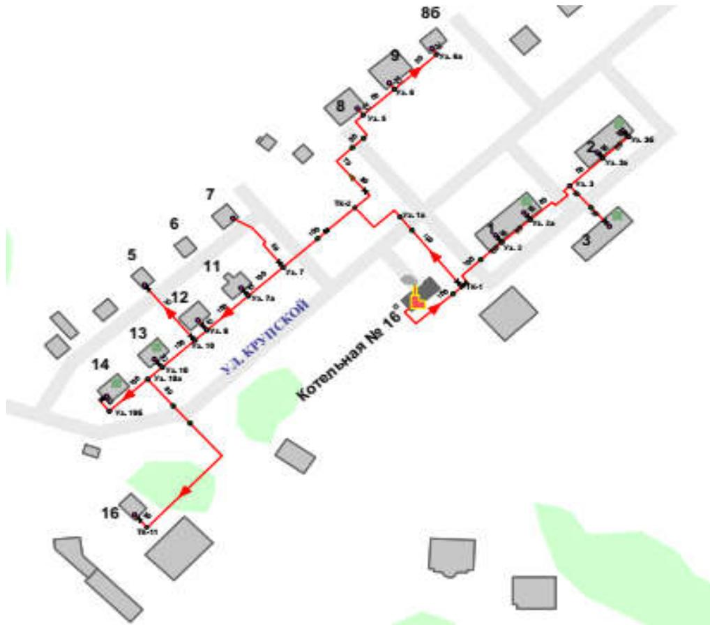
Рисунок 23 Схема тепловых сетей котельной №16
