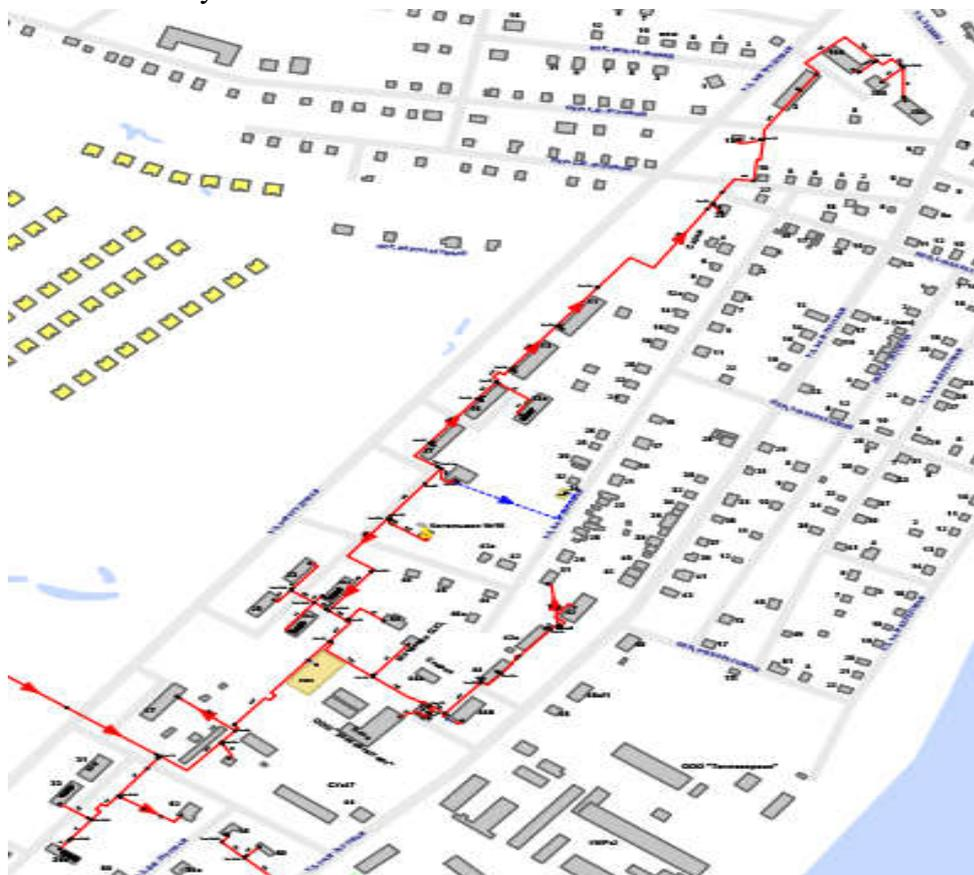
Рисунок 14 Схема тепловых сетей котельной №18
