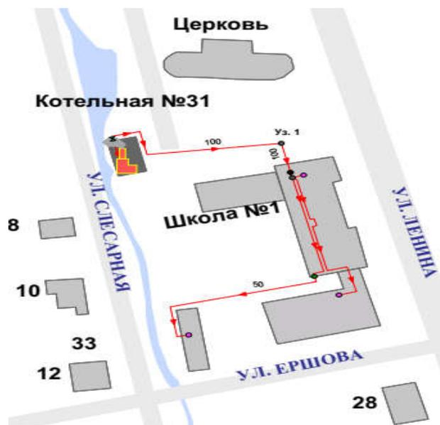
Рисунок 19 Схема тепловых сетей котельной №31
