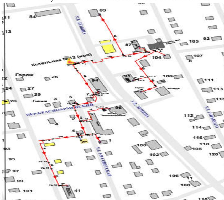
Рисунок 10 Схема тепловых сетей котельной №12
