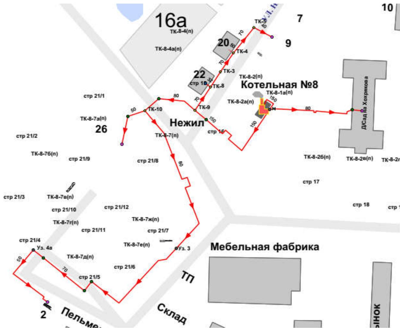
Рисунок 8 Схема тепловых сетей котельной №8
