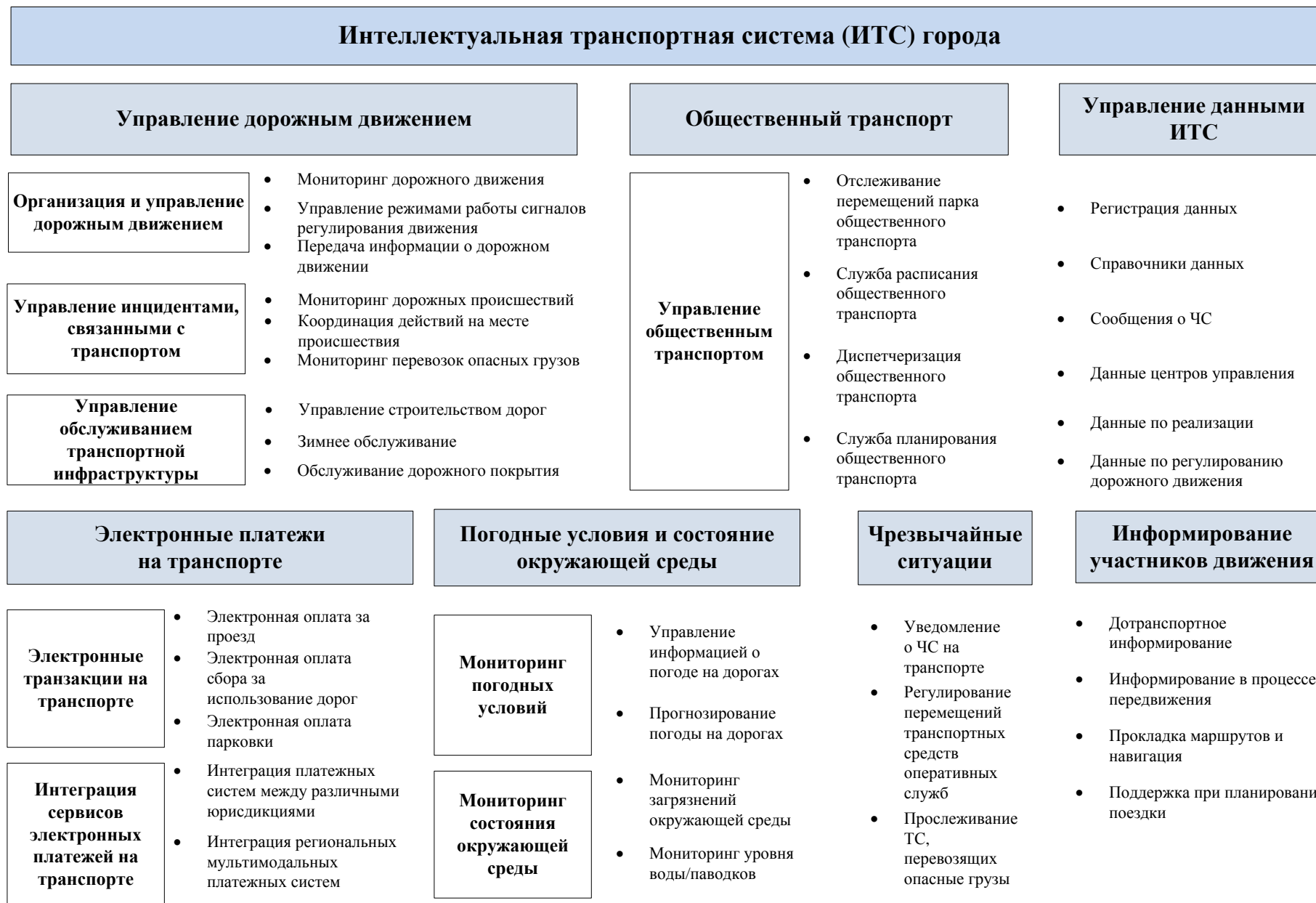
Рисунок 26. Пример построения архитектуры ИТС (по ГОСТ Р ИСО 14813-1-2011 «Схема построения архитектуры интеллектуальных транспортных систем»)
