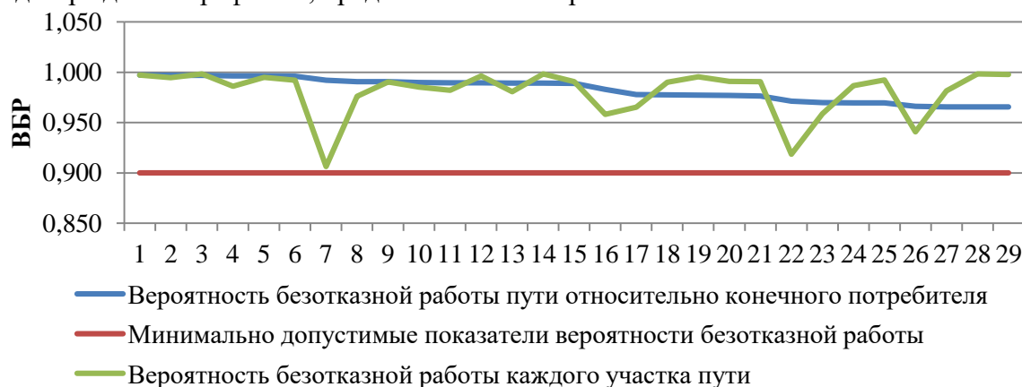
Рисунок 61. ВБР относительно участка тепловой сети от камеры «Вывод - Котельная № 19» до потребителя по ул. Калинина, 5
