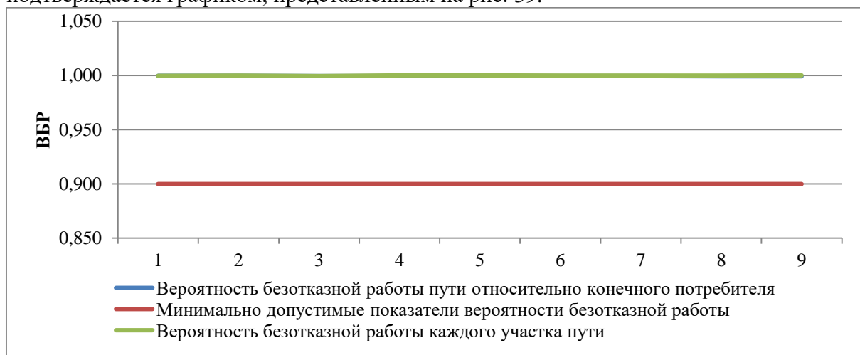
Рисунок 39. ВБР относительно участка тепловой сети от камеры «Вывод Котельная № 17» до потребителя «Пединститут, столовая»
