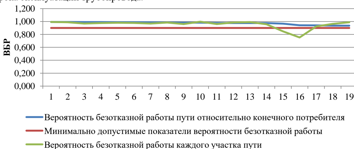
Рисунок 59. ВБР относительно ТК участка тепловой сети от камеры «Вывод - Котельная № 15» до потребителя по ул. Левобережная, 48
