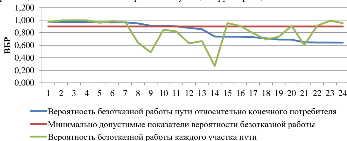
Рисунок 41. ВБР относительно участка тепловой сети от камеры «Вывод Котельная № 18» до потребителя по ул. Ленина, 200
