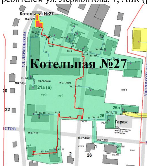
Рисунок 44. Трассировка участка тепловой сети от камеры «Вывод - Котельная № 27» до потребителя ул. Лермонтова, 7, АБК
