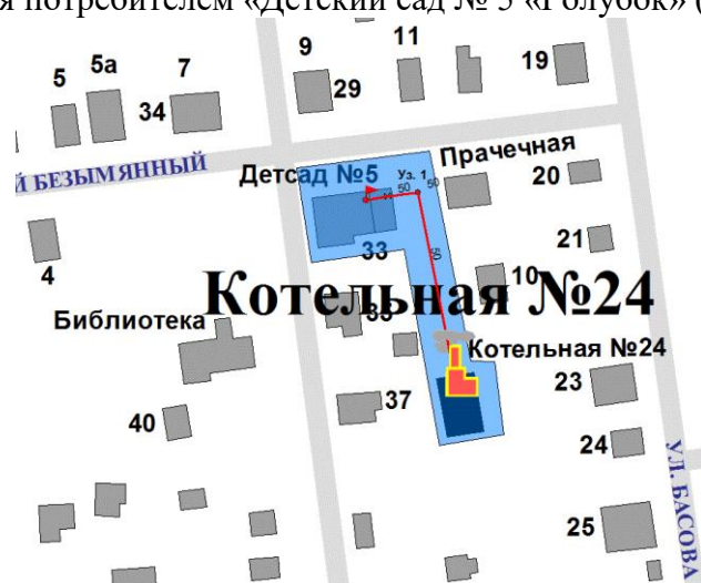
Рисунок 42. Трассировка участка тепловой сети от камеры «Вывод - Котельная № 24» до потребителя «Детский сад № 5 «Голубок»
