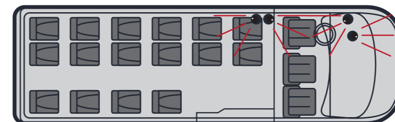
3. Размещение видеокамер в салоне автобуса малого класса вместимости
